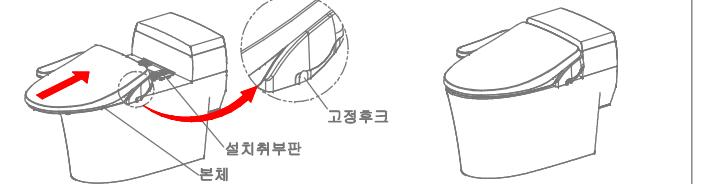
\*본체 하단부에 형성된 취부판 삽입홀에 설치취부판이 바르게 결합되면 본체를 위로 완전히 밀어 넣는다. 이때 고정후크의 막이 걸리는 소리(딸깍)가 나면 결합이 완료된 것입니다.
