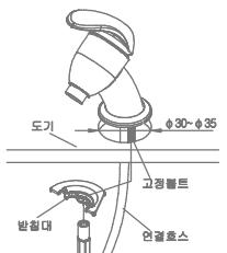
1. 휘부하고자 하는 세면기의 구멍은 반드시  $\phi 30\sim\phi 35mm$ 가 되어야 합니다.
